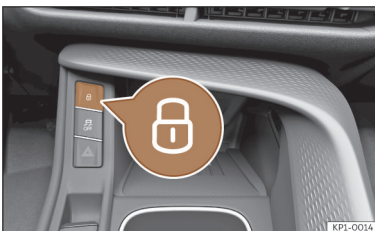
Afb. 76 In de middenconsole: knop voor centrale vergrendeling
