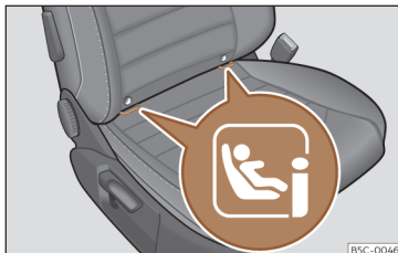
Afb. 41 Bijrijdersstoel: locatie van de i-Size-bevestigingsbeugels.
