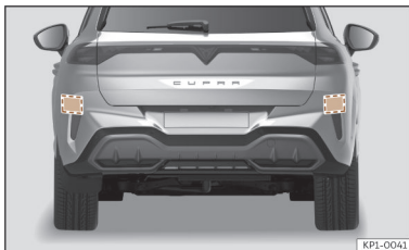
Afb. 126 Achteraanzicht van de wagen: zones van de radarsensoren.
