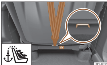
Afb. 44 Achterzijde van de rugleuning van de bijrijdersstoel: verankerung voor de Top Tether-riem (niet in alle markten beschikbaar).
