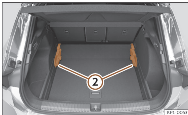
Afb. 186 Verstelbare bodem van de bagageruimte: lage stand.
