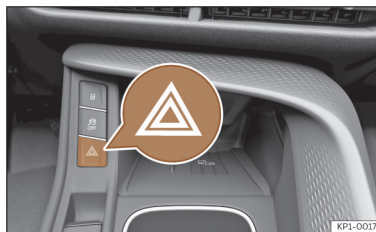
Afb. 48 Middenconsole: schakelaar voor alarmlichten.
