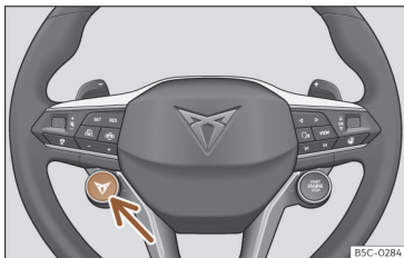
Afb. 120 Multifunctiestuurwiel: knop om het rijprofiel te wisselen.
