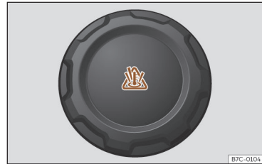
Afb. 223 Voorruimte: vuldop van het koelvloeistofexpansiereservoir.
