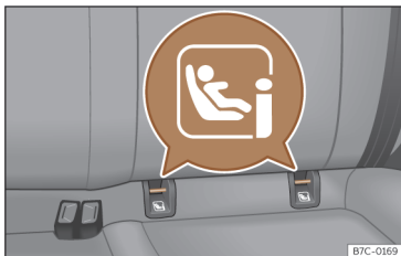
Afb. 40 Achterstoel: locatie van de ISOFIX- of i-Size-bevestigingsbeugels.
