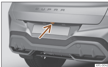
Afb. 128 In de handgreep van de achterklep: inbouwplaats van achteruitrijcamera.
