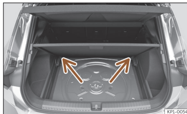
Afb. 187 Verstelbare bodem van de bagageruimte: schuine stand.
