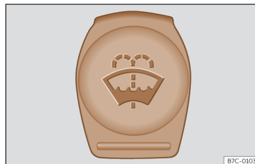
Afb. 225 In de voorruimte: blauwe dop van het ruitensproeier-vloeistofreservoir.
