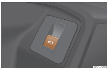
Afb. 83 In het bestuurdersportier: knop om achterklep te openen en sluiten.
