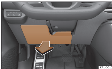
Afb. 215 In het dashboard aan bestuurderszijde: deksel van de zekeringenhouder.
