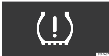
Afb. 244 Instrumentenpaneel: waarschuwing verlies van bandenspanning.
