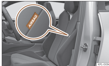
Afb. 34 Zij-airbag in de bestuurdersstoel.
