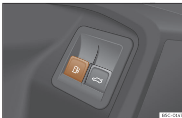
Afb. 202 Bestuurdersportier: ontgrendeling van de tankklep.
