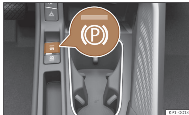
Afb. 147 Onder in de middenconsole: toets van de elektronische parkeerrem.
