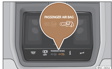
Afb. 31 In de dakconsole: controlelampje van uitschakeling bijrijdersairbag.
