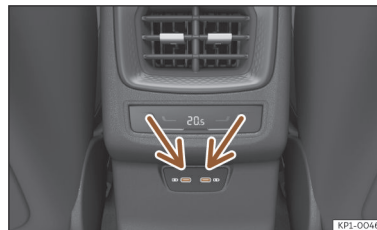
Afb. 174 Achterzijde middenconsole: USB-aansluitingen met functie van stroomvoorziening.
