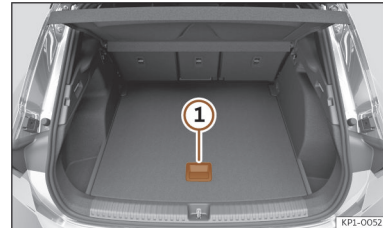
Afb. 185 Verstelbare bodem van de bagageruimte: hoge stand.
