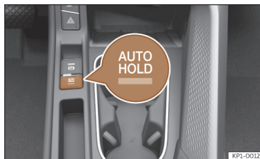
Afb. 148 Onder in de middenconsole: functietoets Auto Hold.
