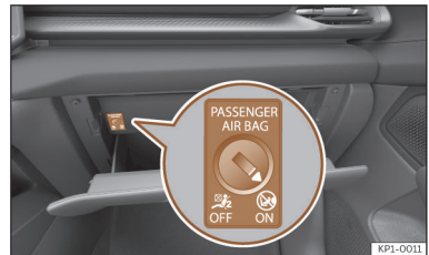
Afb. 30 Sleutelschakelaar voor het in- en uitschakelen van de bijrijdersairbag.
