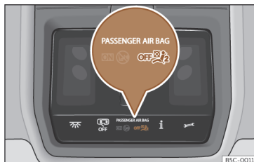
Afb. 28 In de dakconsole: controlelampje van uitschakeling bijrijdersairbag.
