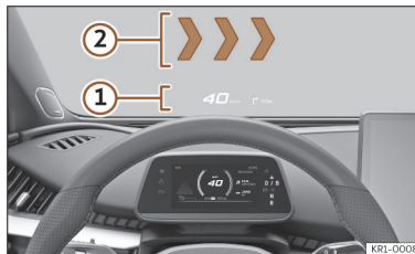
Afb. 4 In het gezichtsveld van de bestuurder: Proximity HUD ① en AR HUD ②.
