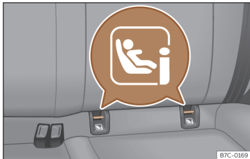
Afb. 37 Achterstoel: locatie van de ISOFIX- of i-Size-bevestigingsbeugels.
