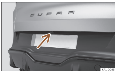
Afb. 117 In de achterbumper: inbouwplaats van achteruitrijcamera.
