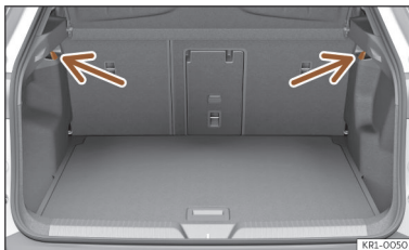
Afb. 171 In de bagageruimte: haken voor tassen.
