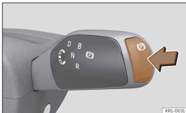
Afb. 137 In de schakelknop: toets van de elektronische parkeerrem.
