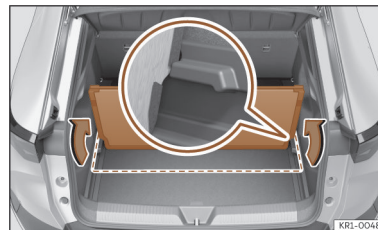
Afb. 169 In de bagageruimte: de tweede bodem van de bagageruimte vastzetten.
