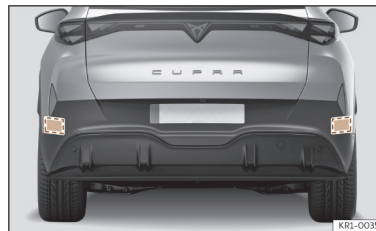
Afb. 115 Achteraanzicht van de wagen: zones van de radarsensoren.
