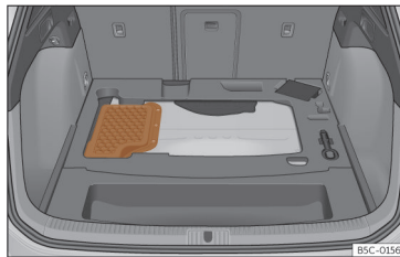
Afb. 238 Hybride wagens (PHEV): locatie van de accu in de bagageruimte
