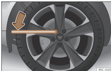
Afb. 248 Wiel verwisselen: wielbouten losdraaien.
