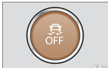
Afb. 129 Onder in de middenconsole: knop voor in-/uitschakeling van ESC (naargelang de uitvoering).
