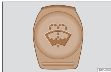
Afb. 226 In de voorruimte: blauwe dop van het ruitensproeier-vloeistofreservoir.
