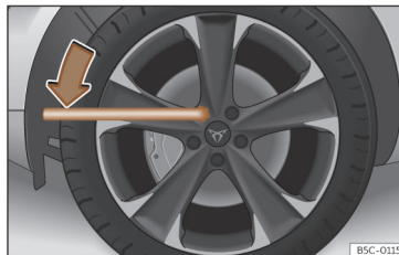
Afb. 242 Wiel verwisselen: wielbouten losdraaien.
