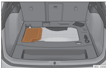
Afb. 232 Hybride wagens (PHEV): locatie van de accu in de bagageruimte
