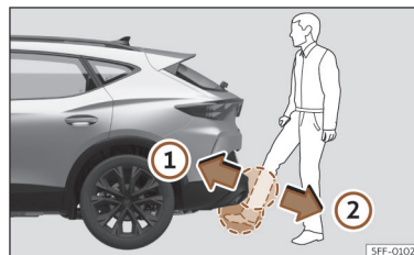
Afb. 86 Achterklep sensorgestuurd openen (Easy Open).
