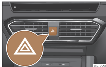
Afb. 50 Dashboard: schakelaar voor alarmlichten.
