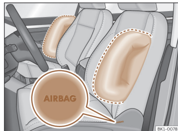
Afb. 32 Zij-airbag in de bestuurders- en bijrijdersstoel.
