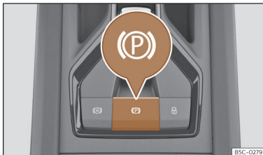
Afb. 155 Onder in de middenconsole: toets van de elektronische parkeerrem.
