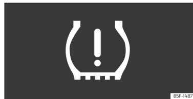
Afb. 245 Instrumentenpaneel: waarschuwing verlies van bandenspanning.
