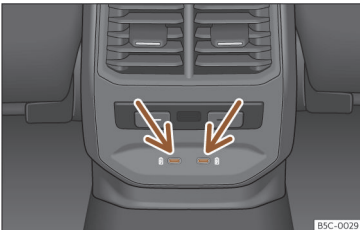
Afb. 178 Achterzijde middenconsole: USB-aansluitingen met functie van stroomvoorziening.
