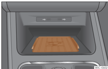
Afb. 184 In de middenconsole: steun voor het aansluiten van de mobiele telefoon.
