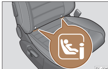
Afb. 41 Bijrijdersstoel: locatie van de i-Size-bevestigingsbeugels.
