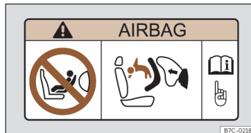
Afb. 38 Airbagsticker: op de zonneklep aan bijrijderszijde.
