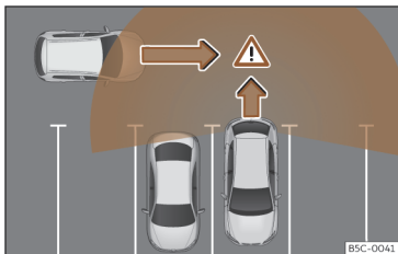
Afb. 169 Schematische voorstelling van de uitparkeerhulp: bewaakt gebied rond de wagen die een parkeerplaats verlaat
