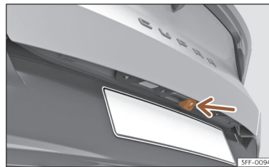
Afb. 136 In de handgreep van de achterklep: inbouwplaats van achteruitrijcamera.
