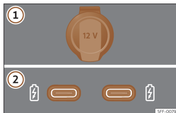
Afb. 175 Stopcontacten van 12 volt in de wagen.
