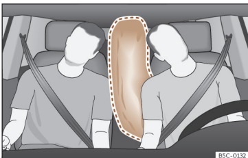
Afb. 31 Volledig opgeblazen centrale airbag (werkingsgebied).
