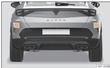
Afb. 134 Achteraanzicht van de wagen: zones van de radarsensoren.
