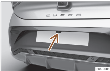
Afb. 114 In de achterbumper: inbouwplaats van achteruitrijcamera.
