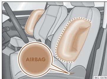
Afb. 30 Zij-airbag in de bestuurders- en bijrijdersstoel.
