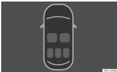
Afb. 17 Instrumentenpaneel: indicatie van de staat van de veiligheidsgordels.
