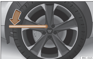
Afb. 195 Wiel verwisselen: wielbouten losdraaien.
