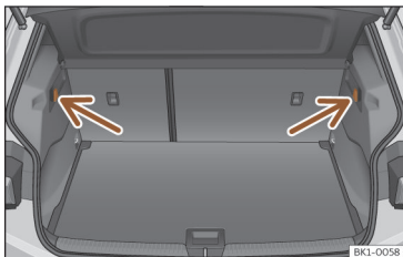
Afb. 167 In de bagageruimte: haken voor tassen.
