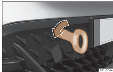
Afb. 178 Voorbumper rechts: ingeschroefd sleepoog.
