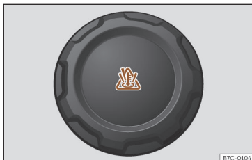
Afb. 186 Voorruimte: vuldop van het koelvloeistofexpansiereservoir.
