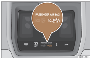
Afb. 27 In de dakconsole: controlelampje van uitschakeling bijrijdersairbag.
