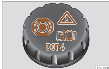
Afb. 187 Voorruimte: dop van het remvloeistofreservoir.
