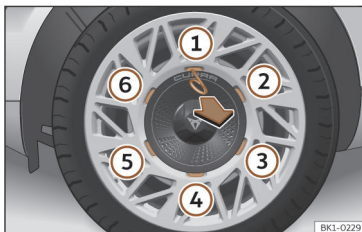
Afb. 192 Wiel verwisselen: de centrale wioldop verwijderen.
