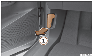
Afb. 194 Ontgrendelingshendel in de voetenruimte van de bestuurder.
