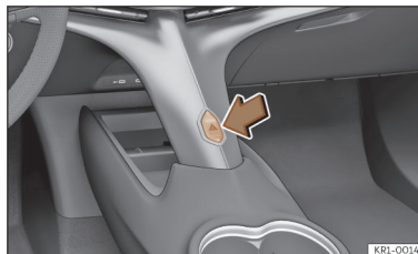
Afb. 45 Middenconsole: schakelaar voor alarmlichten.
