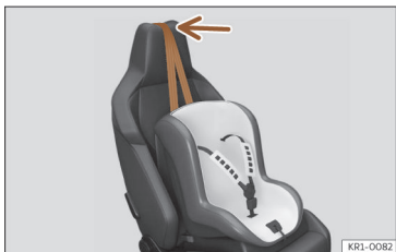
Afb. 43 Stoel van de bestuurder: afstelling en montage volgens de Top Tether-gordel.
