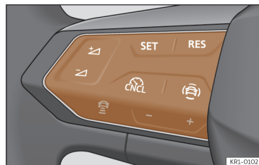
Afb. 115 Op het multifunctiestuurwiel: knoppen voor bediening van het snelheidsregelsysteem.
