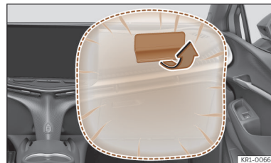
Afb. 26 Bijrijdersairbag in het dashboard.
