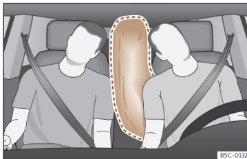
Afb. 30 Volledig opgeblazen centrale airbag (werkingsgebied).
