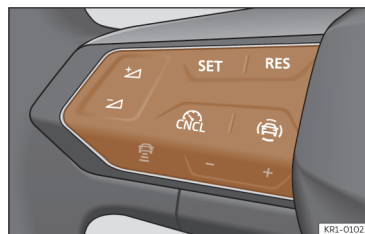
Afb. 131 Linkerzijde van het multifunctiestuurwiel.
