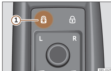
Afb. 76 In het bestuurdersportier: aanraakpaneel voor het elektrische kinderslot.
