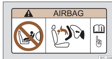
Afb. 35 Airbagsticker: op de zorneklep aan bijrijderszijde.
