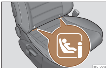
Afb. 38 Bijrijdersstoel: locatie van de i-Size-bevestigingsbeugels.
