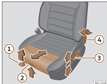
Afb. 84 Voorstoelen: handmatig verstellen van de stoel.
