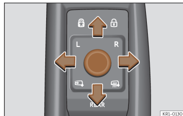
Afb. 98 Detail van het bestuurdersportier: bedieningselement voor buitenspiegel.
