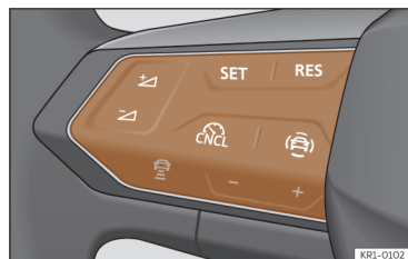
Afb. 119 Op het multifunctiestuurwiel: knoppen voor bediening van ACC.
