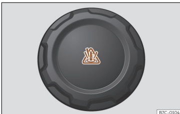
Afb. 197 Voorruimte: vuldop van het koelvloeistofexpansiereservoir.
