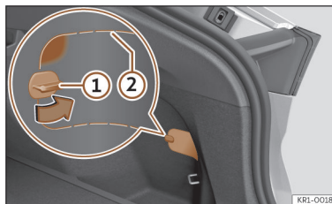
Afb. 61 Rechtsonder aan de bekleding van de bagageruimte: afdekking met snijlijnen.
