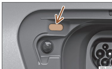
Afb. 59 Achter de acculaadklep: indicator van het laadproces.
