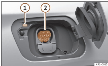
Afb. 56 Achter de laadklep van de accu, rechtsachter: Laadcontactdoos.
