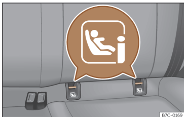
Afb. 37 Achterstoel: locatie van de ISOFIX- of i-Size-bevestigingsbeugels.
