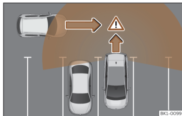
Afb. 151 Schematische voorstelling van de uitparkeerhulp: bewaakt gebied rond de wagen die een parkeerplaats verlaat
