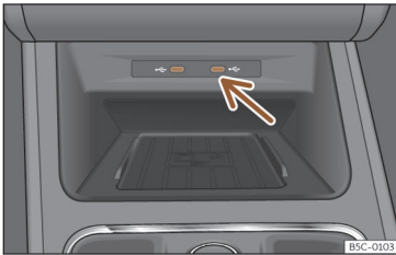
Fig. 174 Centre console: USB input.
