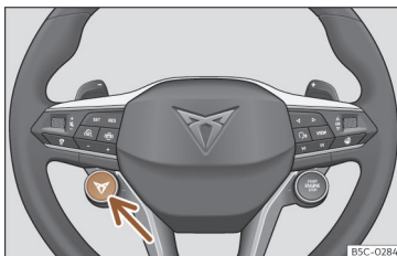
Afb. 125 Multifunctiestuurwiel: knop om het rijprofiel te wisselen.
