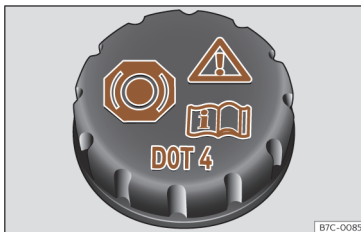
Afb. 220 Voorruiimte: dop van het remvloeistofreservoir.
