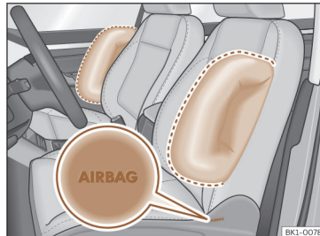
Afb. 31 Zij-airbag in de bestuurders- en bijrijdersstoel.
