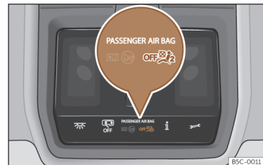
Afb. 28 In de dakconsole: controlelampje van uitschakeling bijrijdersairbag.
