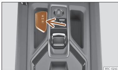
Afb. 70 Middenconsole (met automatische versnellingsbak): houder voor de autosleutel.
