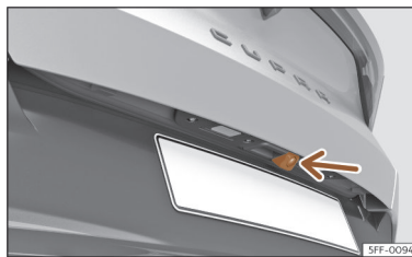
Afb. 133 In de handgreep van de achterklep: inbouwplaats van achteruitrijcamera.
