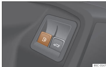
Afb. 201 Bestuurdersportier: ontgrendeling van de tankklep.
