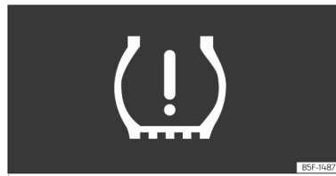
Afb. 240 Instrumentenpaneel: waarschuwing verlies van bandenspanning.
