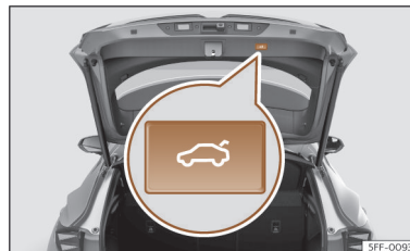
Afb. 82 Achterklep: knop om klep te sluiten.
