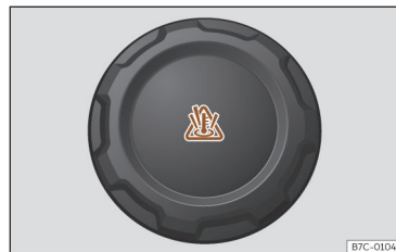
Afb. 219 Voorruimte: vuldop van het koelvloeistofexpansiereservoir.
