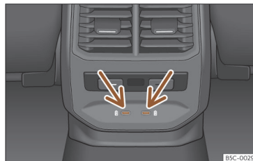
Afb. 175 Achterzijde middenconsole: USB-aansluitingen met functie van stroomvoorziening.
