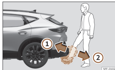
Afb. 84 Achterklep sensorgestuurd openen (Easy Open).
