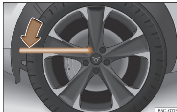
Afb. 237 Wiel verwisselen: wielbouten losdraaien.
