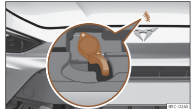
Afb. 216 Hendel onder de motorkap.
