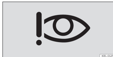
Afb. 7 Op het display van het instrumentenpaneel: Symbool van de aandachtsmonitor van de bestuurder
