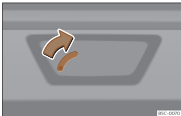
Afb. 86 Deel van de bagageruimte: noodontgrendeling.
