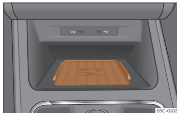
Afb. 181 In de middenconsole: steun voor het aansluiten van de mobiele telefoon.
